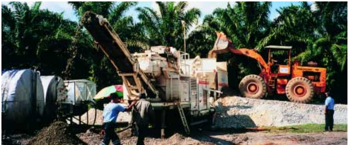
Mezcla en frío, la cual se vuelve propia para el almacenaje durante un período de larga duración: por medio de la KMA 150, en Malasia se produjo un material de construcción de alta calidad para capas de base.
