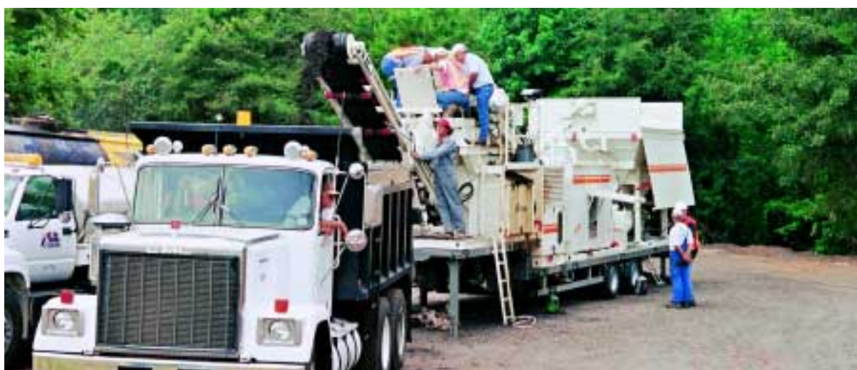
La mezcla en frío de la mezcladora móvil KMA 150 es cargada en camiones: también en Texas/EE.UU se tiene conciencia de la buena calidad del material producido con betún espumado.
