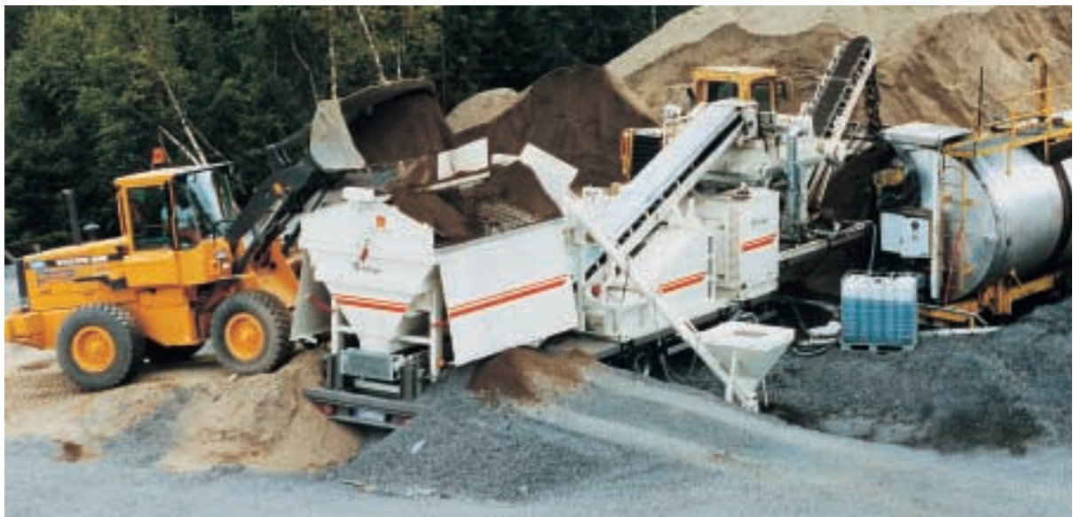
Es posible producir aglomerado de excelente calidad propio para el almacenaje, añadiendo betún espumado, incluso bajo condiciones meteorológicas frías: aquí se aprecia la aplicación de un equipo móvil cerca de Lillehammer/Noruega.
