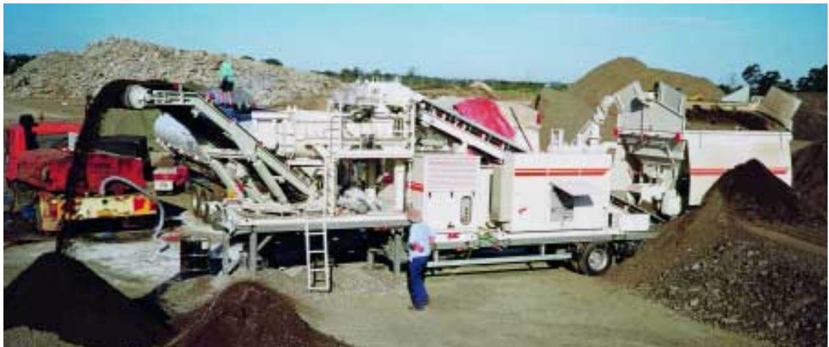
La mezcladora KMA 150 puede ser transportada al sitio de mezcla adecuado. En esta fotografía se aprecia la producción en Australia de una mezcla en frío de alta calidad, añadiendo betún espumado como ligante.
